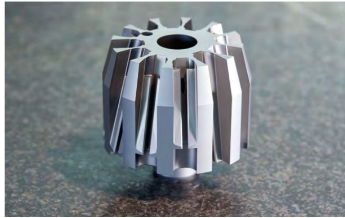
„Konik in Konik in Konik“ – nennt Geschäftsführer Andreas Hornung scherzhaft dieses Werkstück, hinter dem sich allerdings ein Kupplungselement für die Automotive-Industrie verbirgt.
